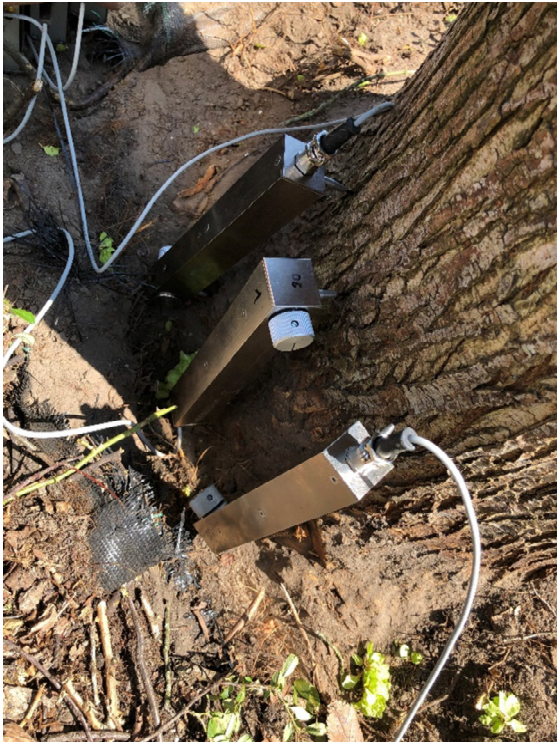
Foto 12: Anbringung der Messtechnik am Stammfuß
