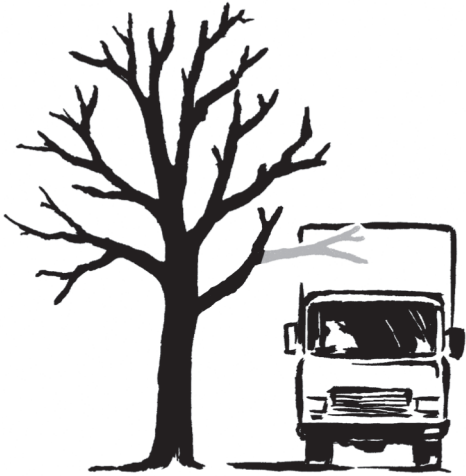
Korrektur Lichtraumprofilschnitt bei Ästen über 10 cm Durchmesser (Schnitt auf Versorgungsast)
